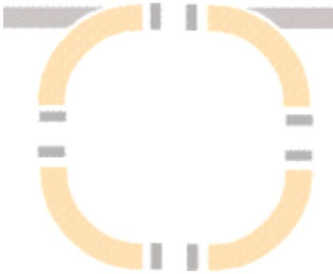
Geladene Teilchen hoher kinetischer Energie verbleiben im Speicherring bis sie zur Verwendung aus dem Synchrotron herausgelenkt werden.
