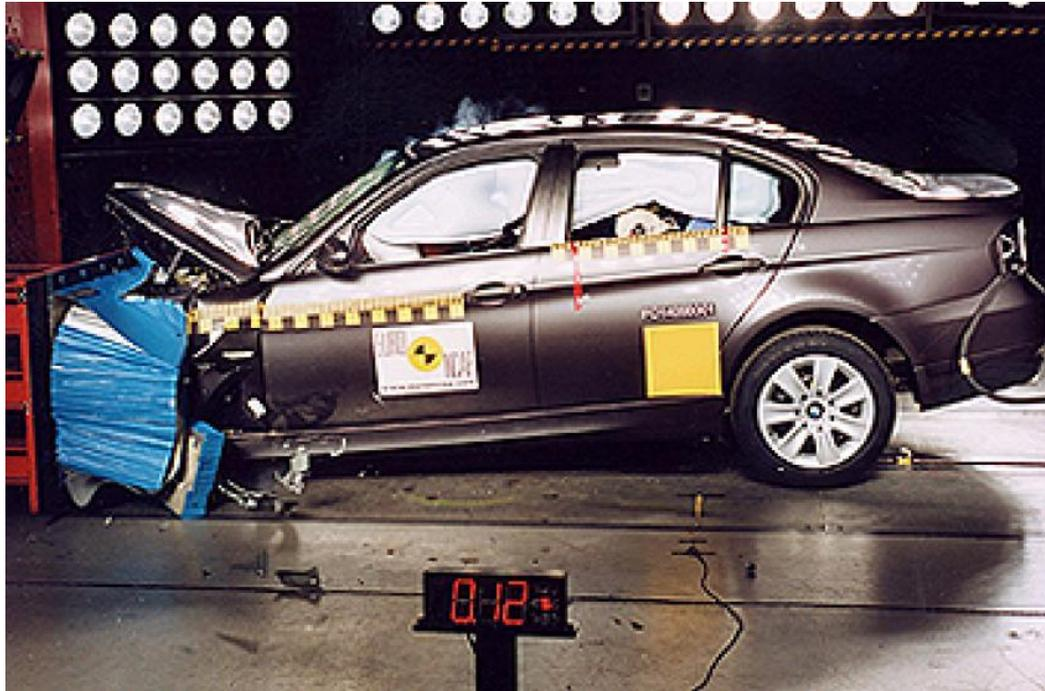
Bei einem Frontalaufprall eines Fahrzeuges wird dessen Geschwindigkeit in kürzester Zeit (0,12s) und in kurzer Wegstrecke auf 0 abgebremst.
