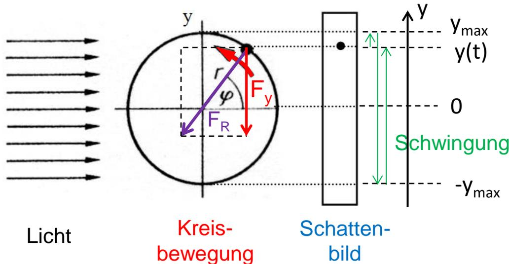
Die Projektion einer gleichförmigen Kreisbewegung in eine Ebene liefert das Bild einer Schwingung.
