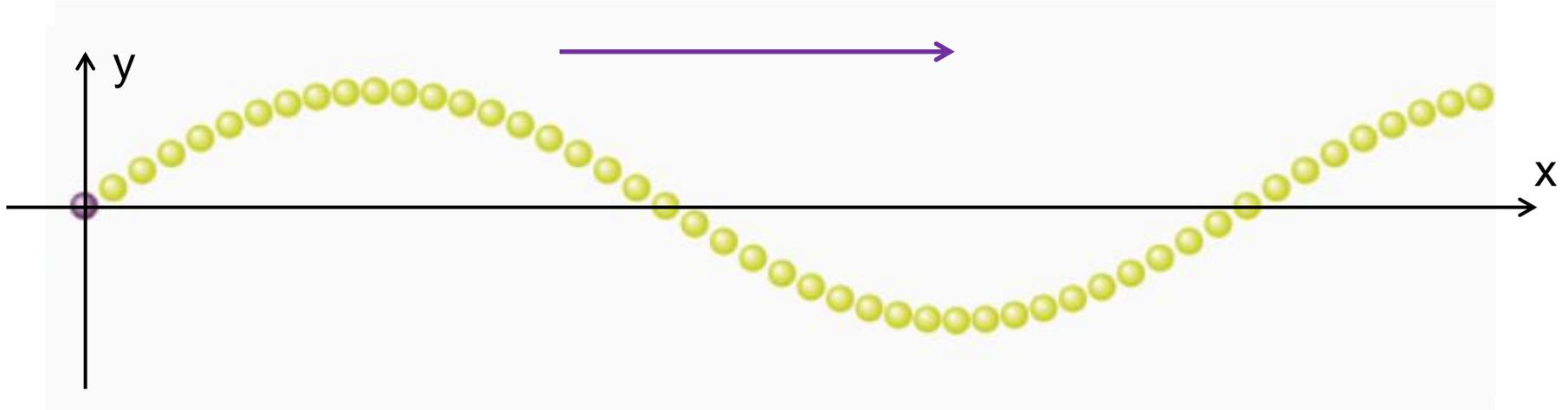
*Der Schwingungszustand breitet sich längs des Wellenträgers in Richtung der x-Achse aus.*
