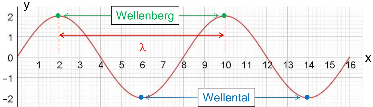
Einzelne Schwinger an verschiedenen Orten befinden sich im gleichen Schwingungszustand.
