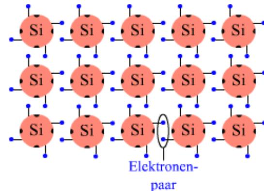
Je ein Außenelektron eines Siliziumatoms bildet mit einem benachbarten Atom ein **Elektronenpaar**.
